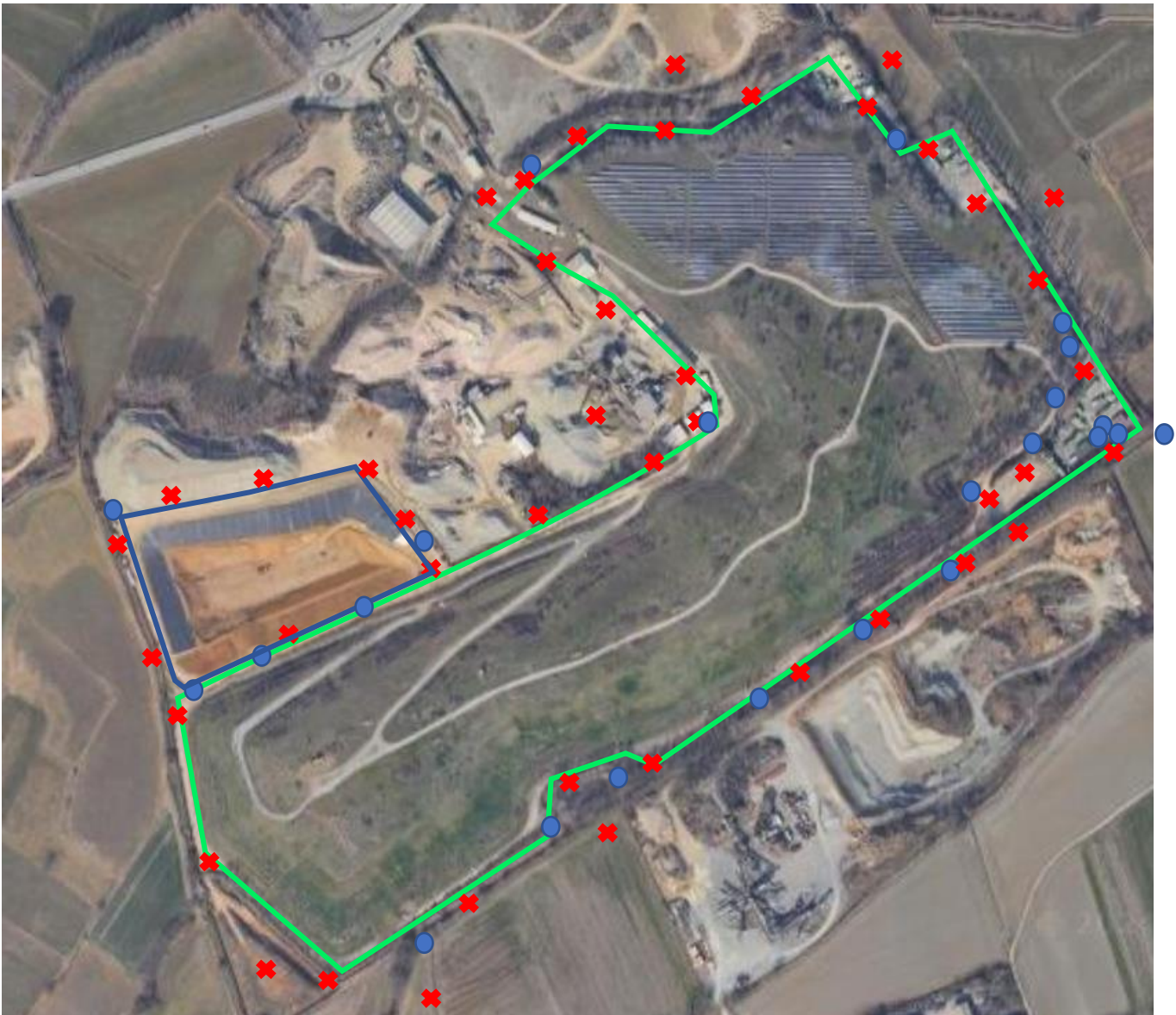
Figura 3: Mappa relativa all'ubicazione dei pozzi di monitoraggio delle acque sotterranee (rappresentati con bolli blu) e di monitoraggio dell'aria interstiziale (rappresentati con la X rossa).
