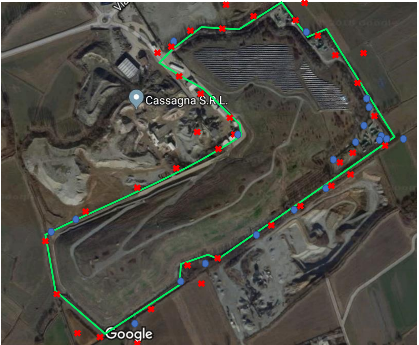
Figura 3: mappa relativa all'ubicazione dei pozzi di monitoraggio delle acque sotterranee (rappresentati con bolli blu) e di monitoraggio dell'aria interstiziale (rappresentati con la X rossa);
